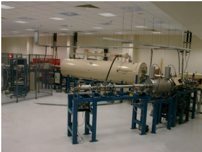
Spectromètre de masse par accélérateur ARTEMIS Laboratoire de mesure du carbone 14 (LMC14), Saclay
