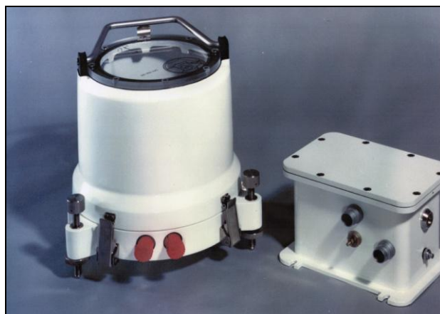
Figure 3 : Sismomètre fonctionnant dans la bande 0,1-20 Hz
