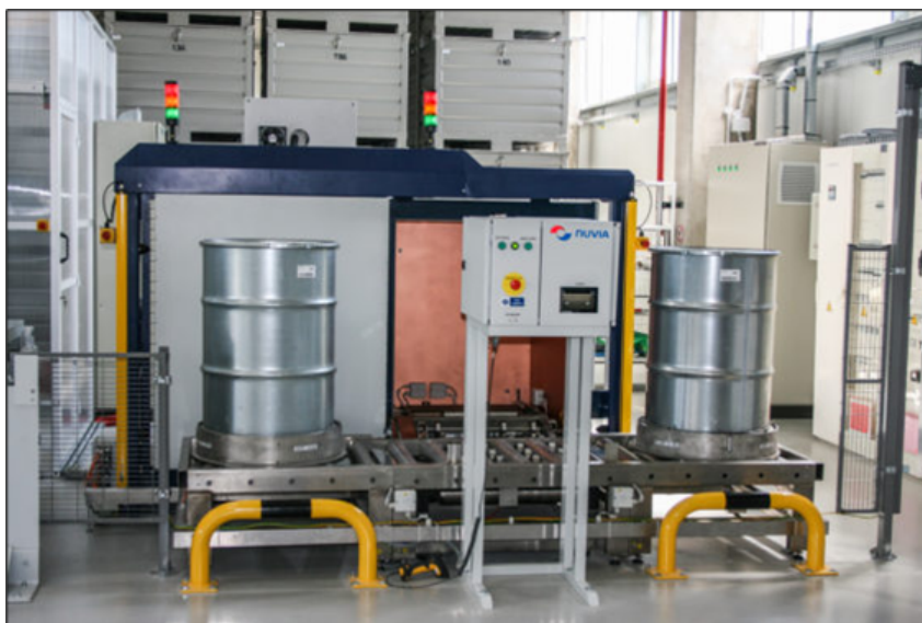
Station de mesure de l'activité de fûts de déchets radioactifs
