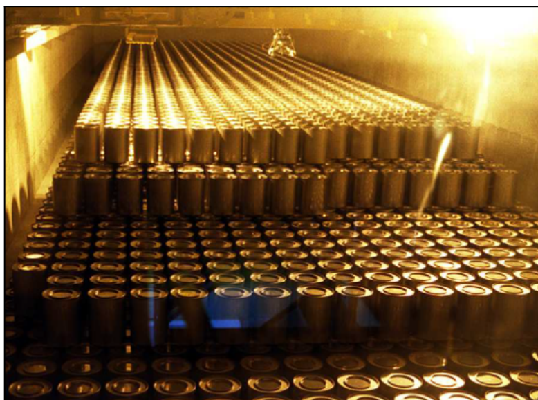
Entreposage de fûts d'enrobés bitumineux à ORANO La Hague
