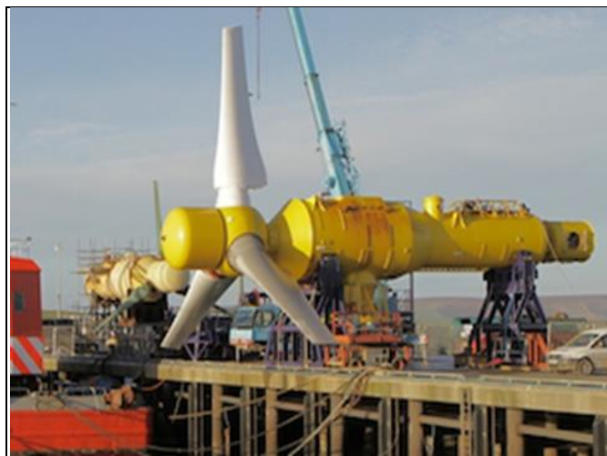
Figure 19 : Prototype d'hydrolienne 1 MW.
