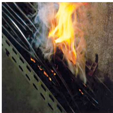
Exemple de départs de feux dans des chemins de câbles et dans une boîte à gants
