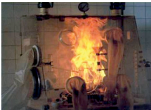
Exemple de départs de feux dans des chemins de câbles et dans une boîte à gants
